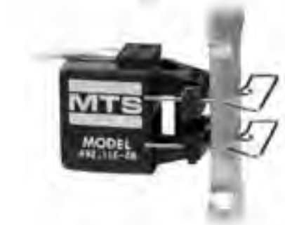
MTS 632.13 型轴向引伸计， 图示包括平板型样品的 快速安装附件；
