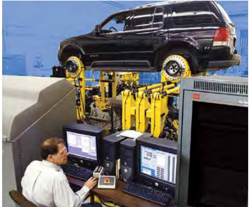
MTS 329 轴耦合整车道路模拟试验系统
