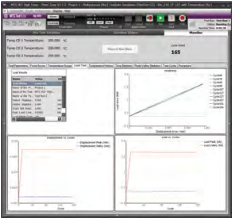
运行时显示提供了高级高周疲劳数据展示的完整功能，包括滞后环曲线、峰值谷值变形量和载荷、载荷-时间数据等等。
