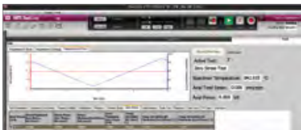
运行“0”应力测试，简单的试验控制流程实现真正的零机械应力，让温度循环起来同时监控应力变化。
