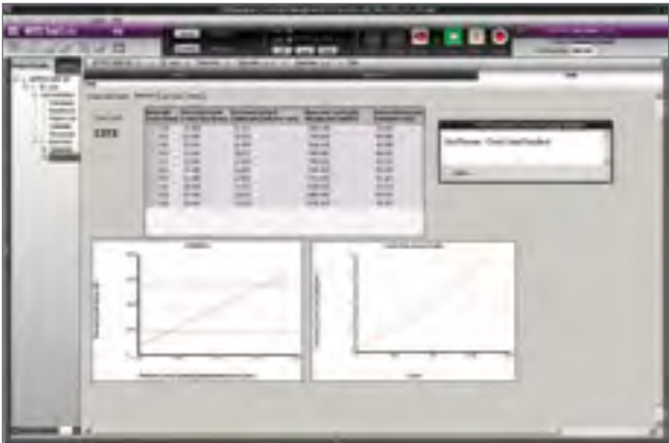
在运行J1c测试应用时，运行时显示可以将显示J积分、裂纹长度-循环、载荷-COD等数据。
