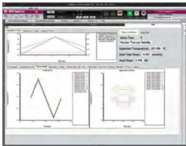
运行时显示可以显示温度循环稳定状态以及必要的温度梯度误差。
