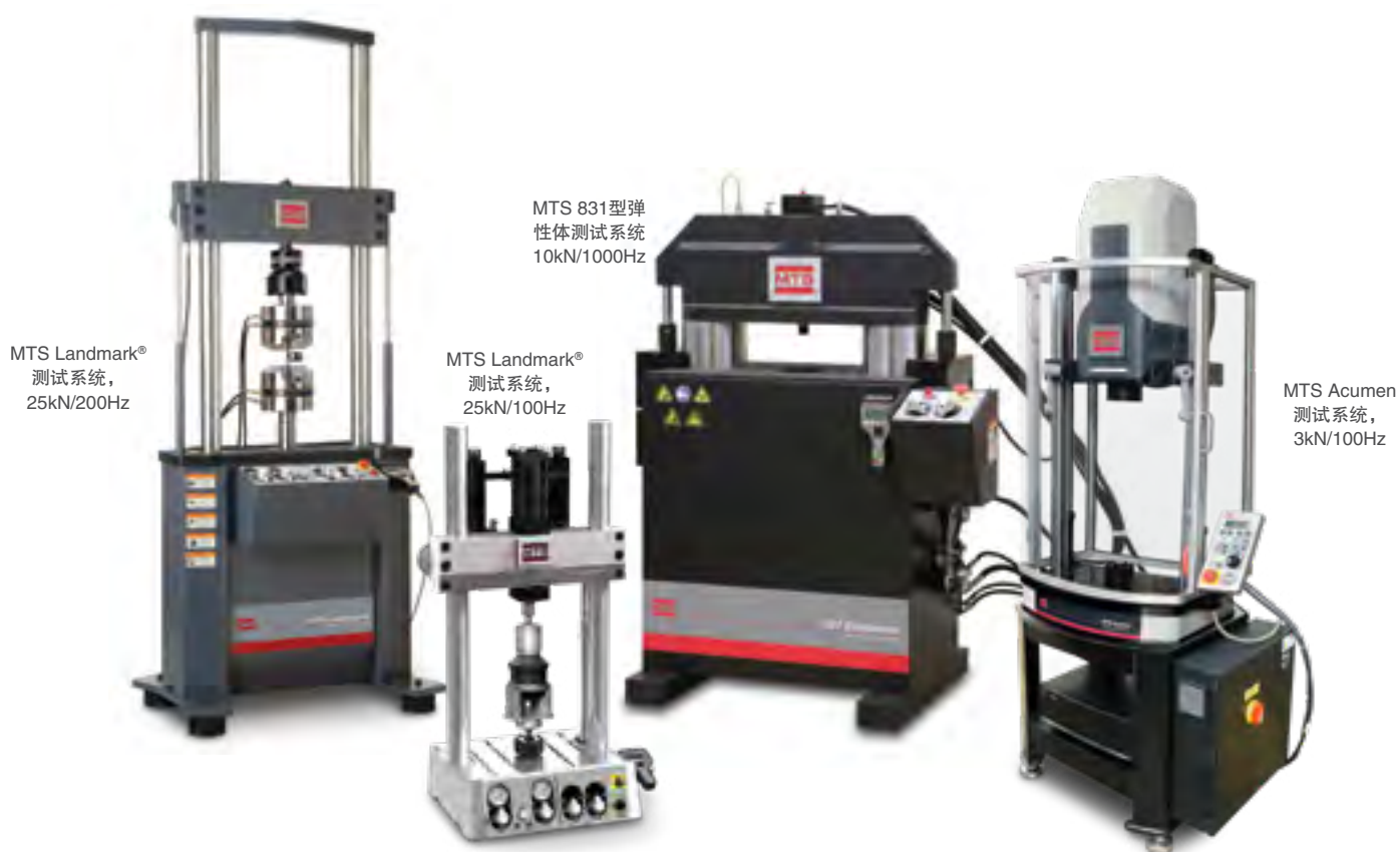
用于粘弹性材料力学测试的MTS测试系统
