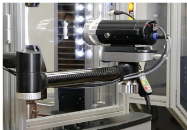
每组Advantage系列视频引伸计的测量镜头都配置有可溯源的校准模块，可用于针对各类型测试要求实现快速校准。这些校准模块具有ISO 17025可溯源校准报告。
