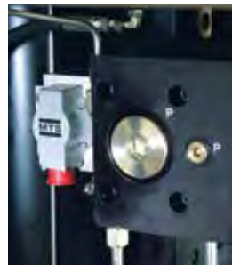
电液伺服阀(高流量高速度、中等流量中等速度和小流量低速度配置)
