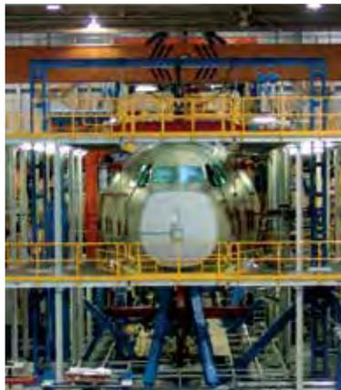
“我们现在对A400M的全机静力和疲劳测试能够做到了然于胸，在试验过程中，样件得到了有效的保护，避免出现任何意外破坏”
